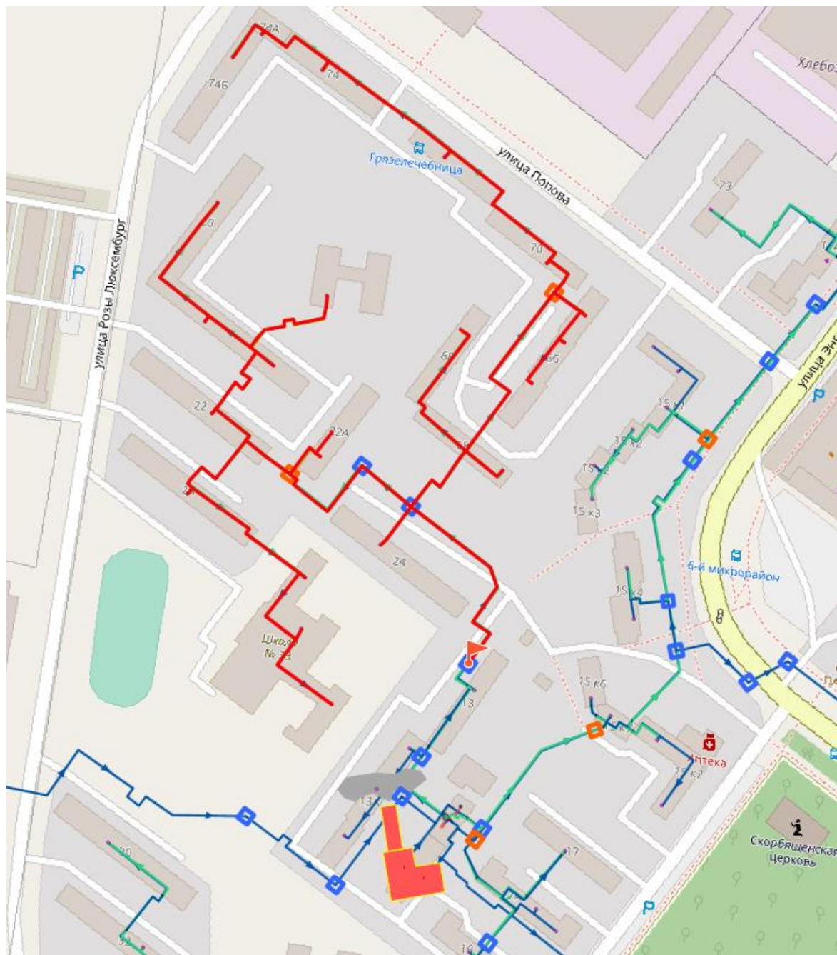
Рисунок 44. Участки тепловых сетей, которые попадают в зону аварийного отключения при повреждении участка тепловой сети от 3/5-ТК-4 до 3/5-ТК-5
